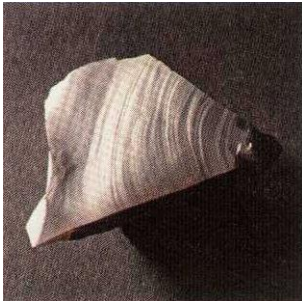
Det muslede brud, som er så karakteristisk for Si-forbindelser som obsidian flint og glas.
